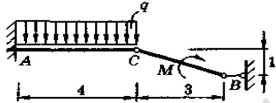
$M = 20 \text{ кН}\cdot\text{м}; q = 40 \text{ кН/м}$
