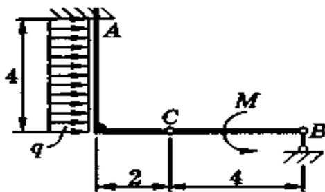
$M = 32 \text{ кН}\cdot\text{м}; q = 15 \text{ кН/м}$
