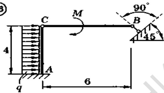
$M = 60 \text{ кН}\cdot\text{м}; q = 25 \text{ кН/м}$
