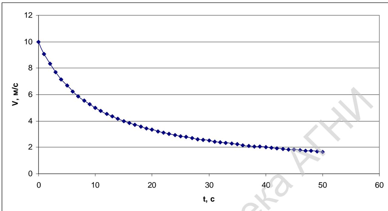
Зависимость  $u = u(t)$  при  $u(0) = 10 \text{ м/с}$
