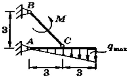
$M = 60 \text{ кН}\cdot\text{м}; q_{\text{max}} = 12 \text{ кН/м}$
